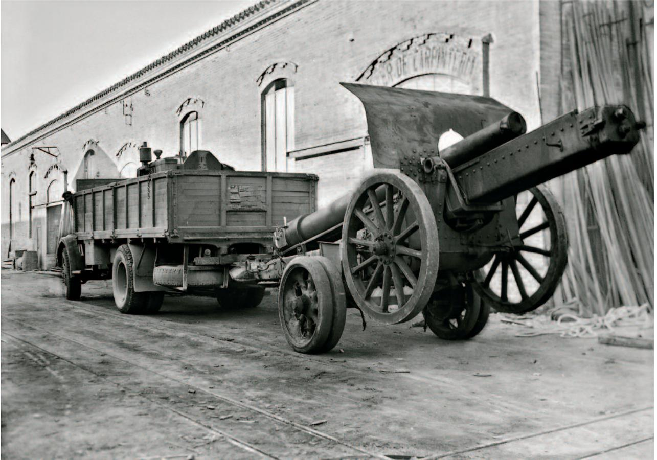
*Cañón de acero de 149,1/27, tiro rápido Krupp, modelo 1913, sobre un carrillo de transporte enganchado a un camión cargado con el tractor marca Caterpillar, base del blindado Mercier I* | 67
