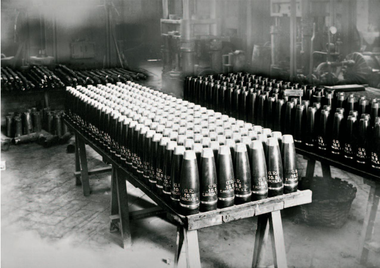
30 | *Proyectiles de artillería del calibre 10,5 sin espoletar listos para ser cargados. Las iniciales G R significan «granadas rompedoras»; son de fundición acerada calculada por Mercier y declarada modelo oficial*
