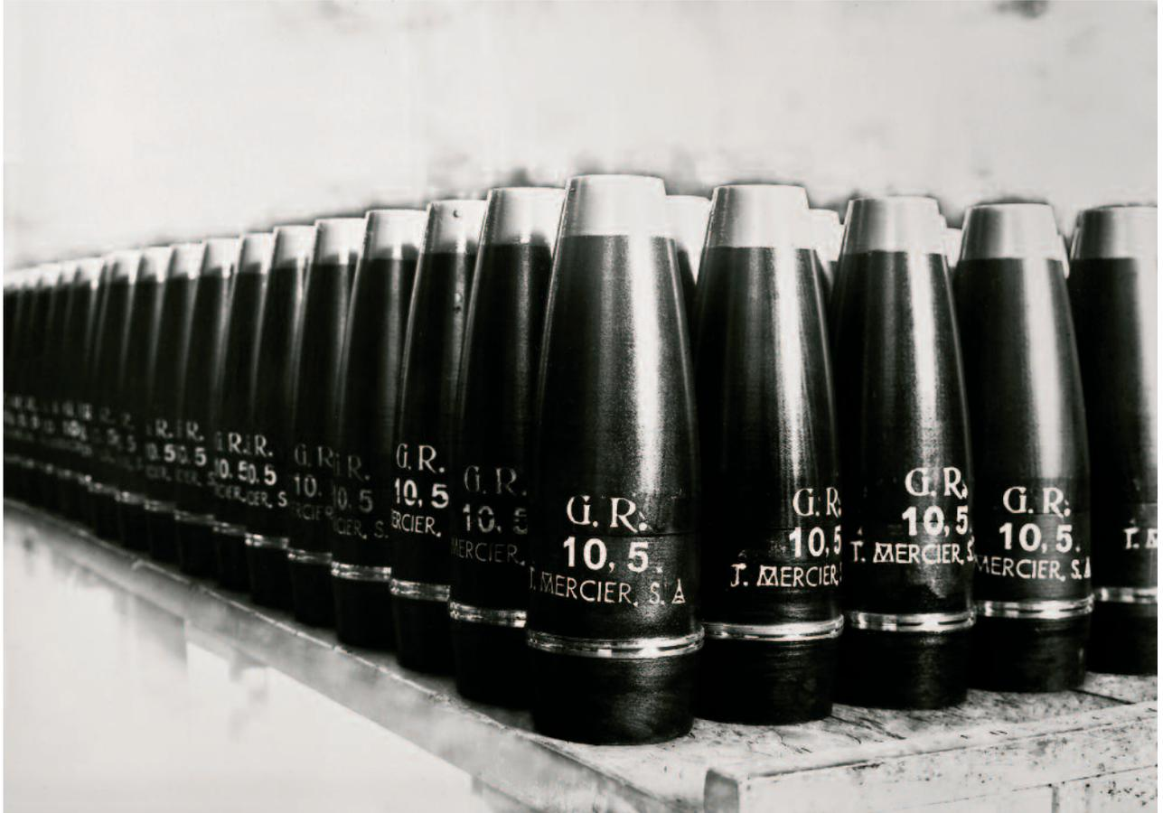
*Proyectiles de artillería del calibre 10,5 sin espoletar* | 31
