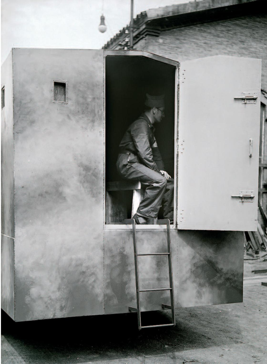
*Entrada trasera al camión blindado Ebro a través de una escalera metálica, mientras el operario simula ver por una de las mirillas del vehículo* | 47
