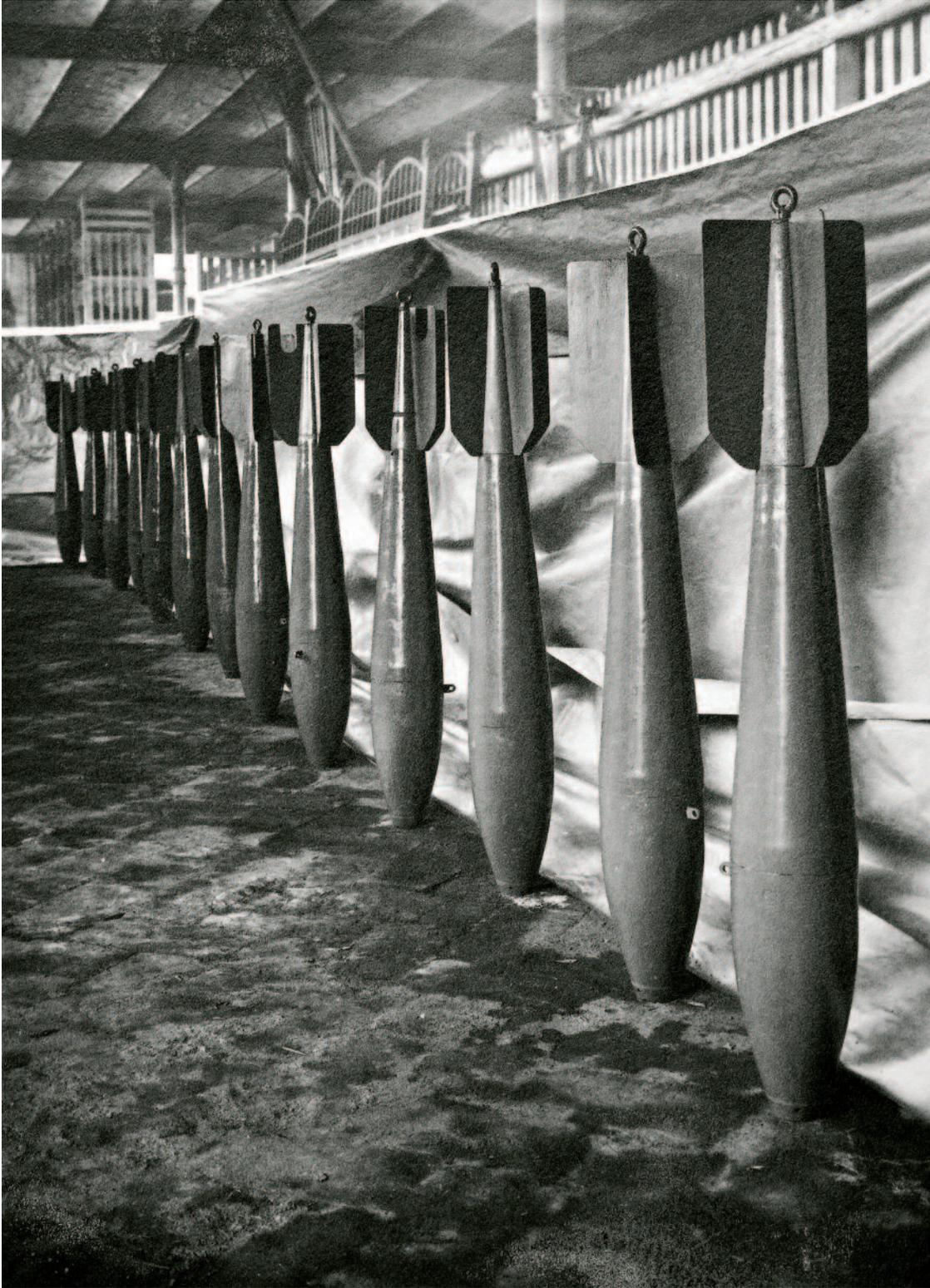
*Bombas de aviación Hispanas de 50 kg ensambladas, con aletas estabilizadoras pero sin espoletar* | 39
