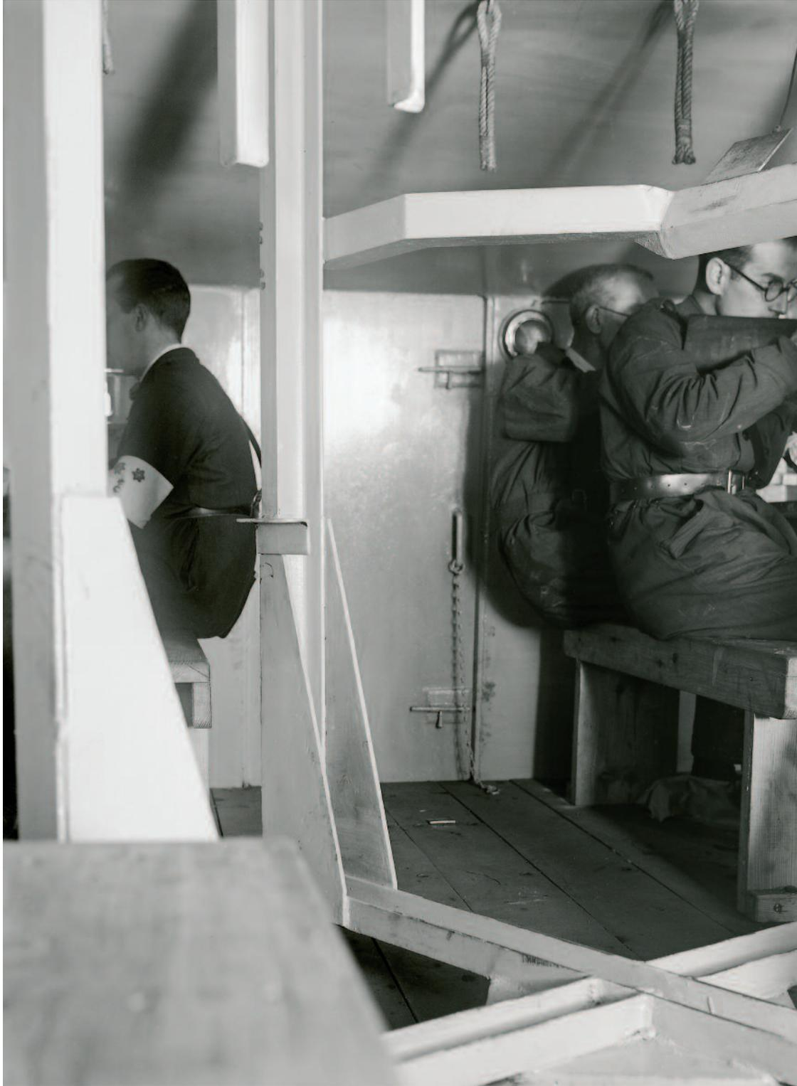
*Extremo opuesto de la caja del camión Mercier II con tres técnicos simulando ser fusileros; la puerta de entrada con dos pestillos (a la dcha. el ingeniero J. M. Tertre)* | 53
