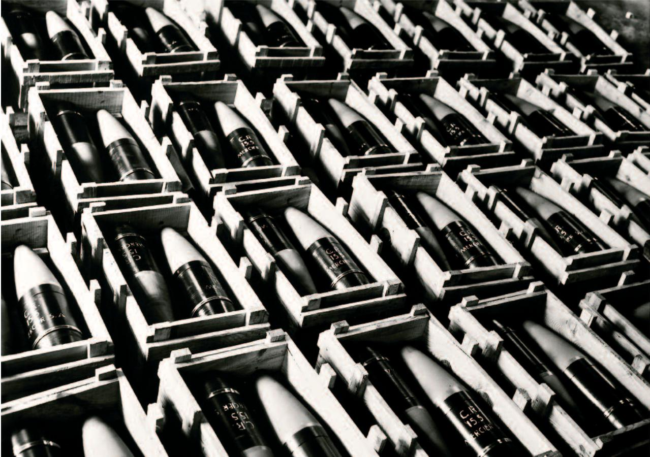
26 | *Proyectiles del calibre 15,5 embalados en cajas de transporte*
