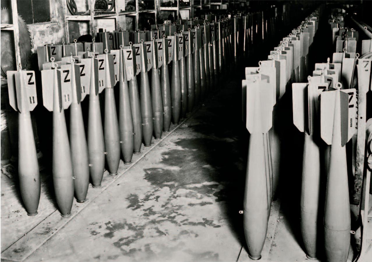
38 | *Bombas de aviación Hispanas de 50 kg, sin espoletar, apiladas para su carga*
