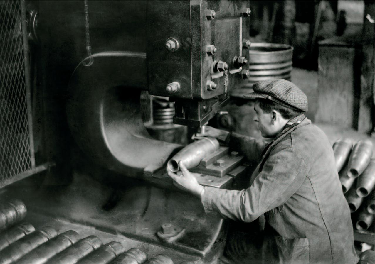
16 | *Colocación de la banda de forzamiento a un proyectil del calibre 10,5*
