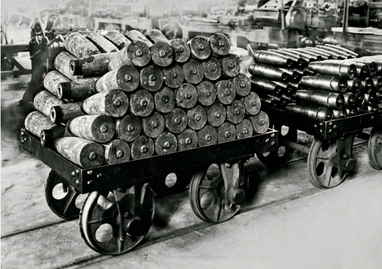
24 | *Proyectiles de artillería del calibre 10,5 sin espoletar, en vagonetas para su transporte*
