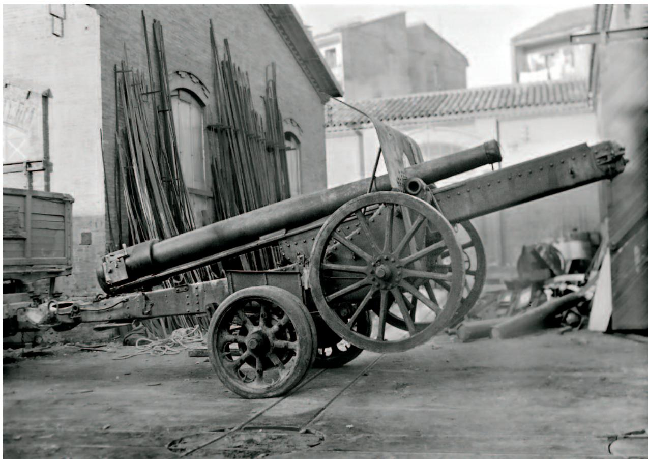
68 | *Cañón de acero de 149,1/27, tiro rápido Krupp, modelo 1913, sobre un carrillo de transporte enganchado a un camión, con el tubo sacado de batería (se ha deformado su posición normal para disparo con el objeto de que los pesos en ruta se estabilicen)*
