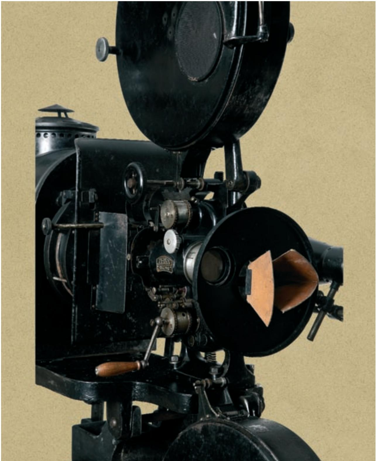
Detalle del crono y lente de un proyector cinematográfico mudo de cabina de la marca Zeiss Ikon (Dresde, Alemania, h. 1920), distribuido por Jesús Daroca. Colección Cinematográfica Daroca.
